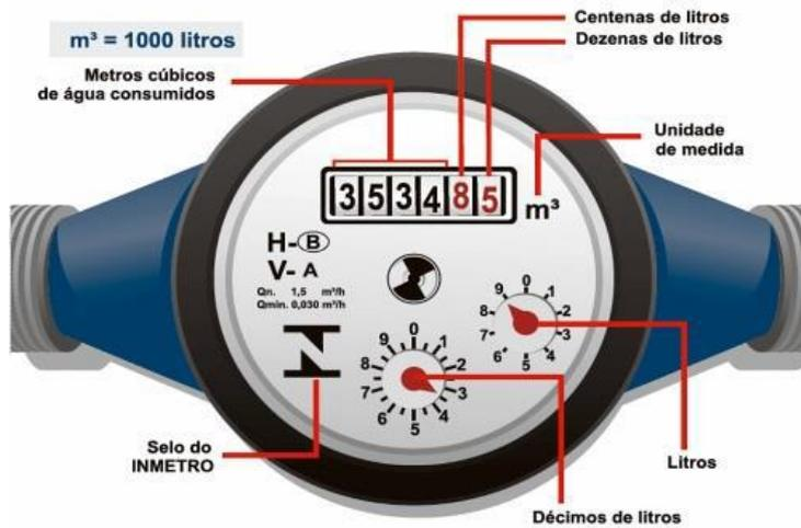
Figura 4: Leitura do Hidrômetro analógico
